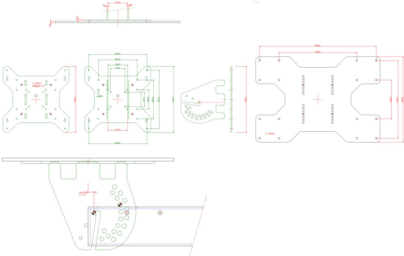
**Aufnahmeplatte/ mounting plate BI 8x440x600 mm**
